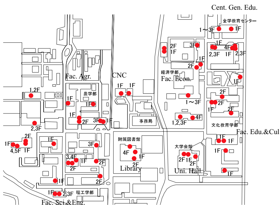
図 3.7: 無線 LAN 装置設置箇所
